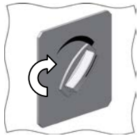
Afb. 30: Draaigreep voor rookgasklep
