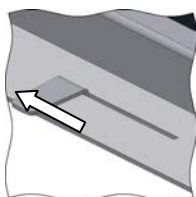
Immagine 41: comando per l'aria di combustione
