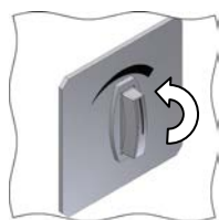
III. 35 : Bouton clapet de fumée
