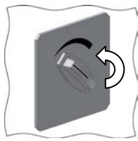
Bild 42: Drehgriff für Rauchklappe
