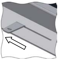
Bild 38: Luftschieber für Verbrennungsluft
