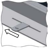
Illustration 27 : Manette de réglage de l'air de combustion
