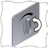
Bild 28: Drehgriff für Rauchklappe
