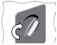
Illustration 30 :Bouton du clapet de fumée
