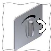
Afb. 35: Draaigreep voor rookgasklep
