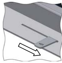
Illustration 20 : Manette de réglage de l'air de combustion
