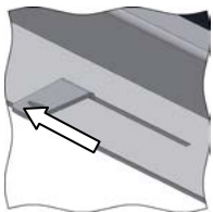
Immagine 45: comando per l'aria di combustione
