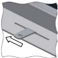
Immagine 27: comando per l'aria di combustione
