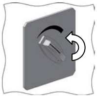
Bild 46: Drehgriff für Rauchklappe
