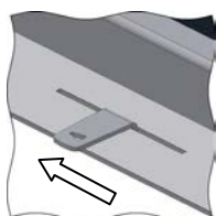
Immagine 34: comando per l'aria di combustione
