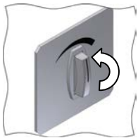
Illustration 28 : Bouton du clapet de fumée
