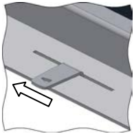
Bild 27: Luftschieber für Verbrennungsluft
