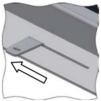
Bild 45: Luftschieber für Verbrennungsluft
