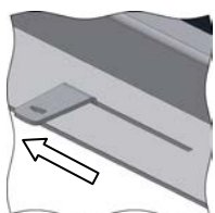
Illustration 38 : Manette de réglage de l'air de combustion
