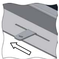
III. 34 : Manette de réglage de l'air de combustion
