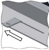
Bild 41: Luftschieber für Verbrennungsluft
