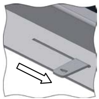
Illustration 33 : Manette de réglage de l'air de combustion
