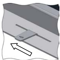
Bild 34: Luftschieber für Verbrennungsluft
