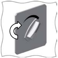
Afb. 37: Draaigreep voor rookgasklep
