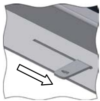
Bild 33: Luftschieber für Verbrennungsluft
