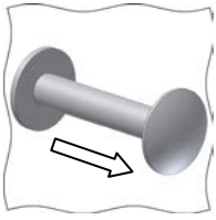
Bild 26: Griff von Klappe für Verbrennungsluft
