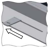
Illustration 45 : Manette de réglage de l'air de combustion
