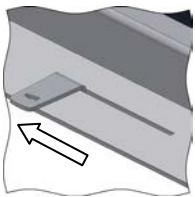
Immagine 38: comando per l'aria di combustione
