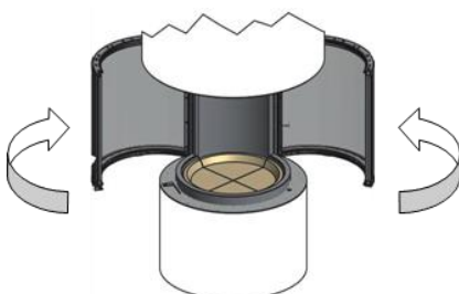
Illustration 51 : Ouverture latérale de la porte
