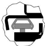
Slika 63: C-stebriček in vodilni valji
