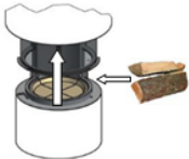
Fig. 31: Raise door and add wood
