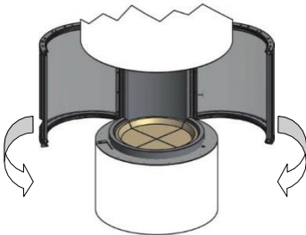
Bild 52: Türe beidseitig zuschwenken
