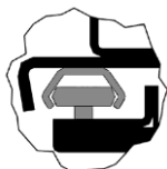
Illustration 63 : Glissière en C et galets de guidage
