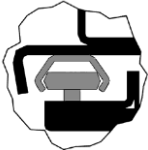
Afb. 63: C-rail en geleidingsrollen
