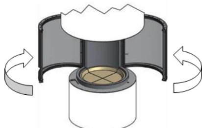
Slika 57: Odprite vrata na obeh straneh.
