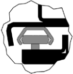
Bild 63: C-Schiene und Führungsrollen
