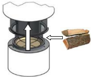
Bild 31: Türe hochschieben und Holz nachlegen
