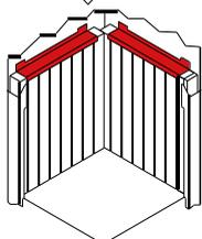
Avvitare la staffa di fissaggio alla parete del focolare.
